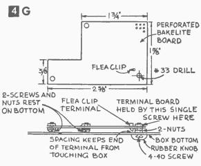
TERMINAL BOARD FOR FILTER CAPACITORS
